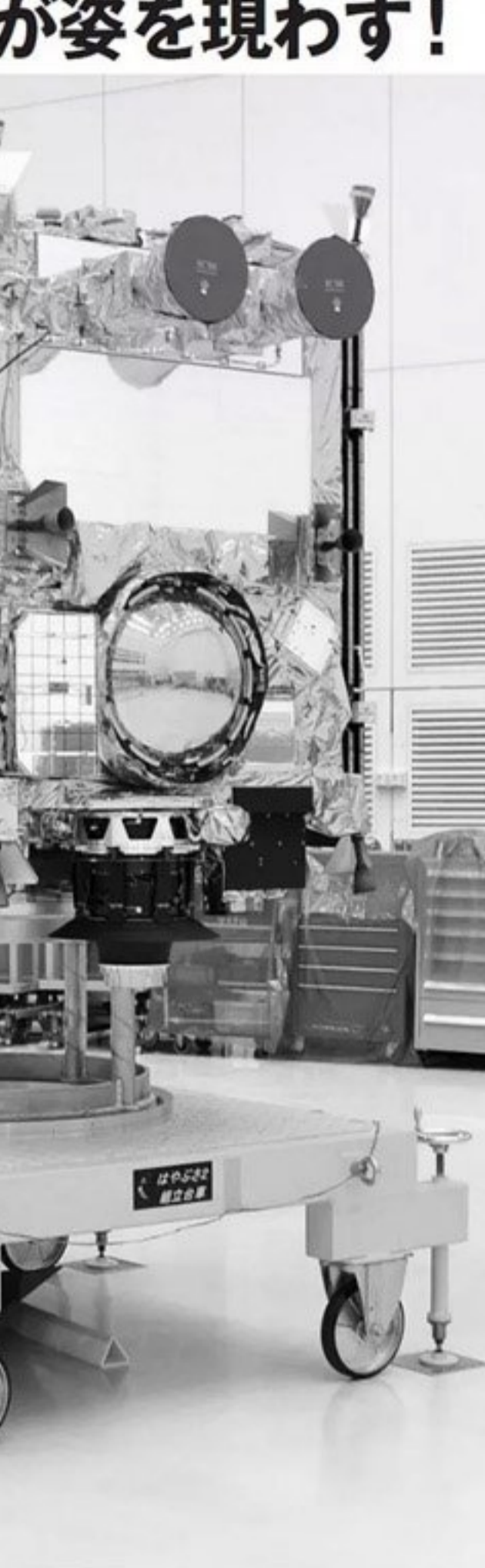
鹿児島県の種子島宇宙センターで報道陣に公開された、はやぶさ2。今後は「リュウグウ」に着陸して、表面や地下の岩石を採取。カメラなどの装置で地形や鉱物分布を調査。小型着陸機を投下して表面の直接観測などを予定
